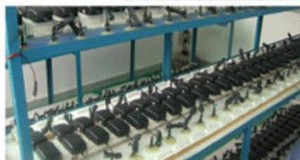
电源、摄像机老化区
